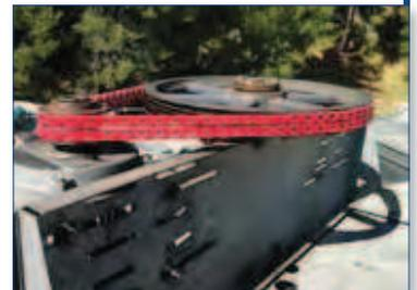
**Solución:** al poder reemplazar las correas trapezoidales PowerTwist Plus, ahora el equipo de mantenimiento lleva siempre cajas con correas rojas. El mantenimiento de las unidades se realiza rápidamente, sin perder tiempo en busca de la correa específica. El inventario se redujo a solo unas pocas cajas de secciones 3L, A/13 y B/17.
