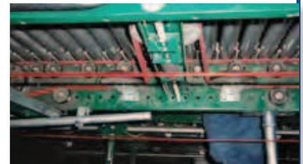
**Solución:** el tiempo de instalación de la correa PowerTwist Roller Drive en esta aplicación se midió en minutos, en lugar de horas. Una vez que las correas estuvieron instaladas, la correa PowerTwist Roller Drive duró tres veces más en el sistema de transportador más problemático que una correa de caucho.
