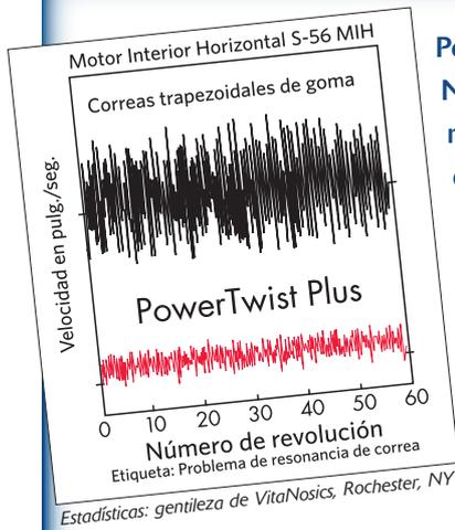
PowerTwist Plus, NuTLink y SuperTLink no tienen los cordones de tensión continua que se encuentran en las correas trapezoidales tradicionales. En consecuencia, la vibración que se transmite en el sistema se puede
