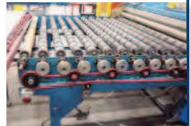
**Solución:** la firma de ingeniería eligió la correa PowerTwist Cushion Top porque se podía ajustar a cualquier largo según la unidad transportadora, y la correa tiene una superficie lisa/flexible que se ajusta a las variaciones de la máquina y tiene una fuerza más que adecuada para la transmisión de la potencia necesaria.
