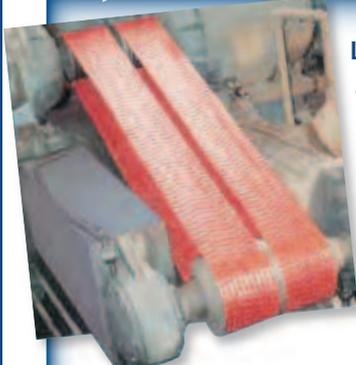
Las correas compuestas de alto rendimiento están fabricadas con materiales compuestos de poliuretano/ poliéster de alto rendimiento, lo cual garantiza una durabilidad excelente aún bajo las condiciones más exigentes. Las correas
